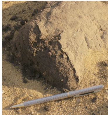
Fig.2 ナイルシルトの日乾煉瓦
